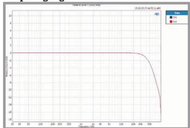
Linearer gehts kaum: Der Frequenzverlauf zeigt sich über die gesamte Hörbreite schnurgerade. Erst bei 50 Kilohertz ist ein Abfall von 3 Dezibel zu verzeichnen
