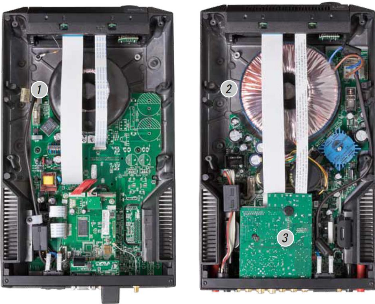
Bei Cyrus steht die Welt Kopf. Die Platinen sind an der Oberseite verschraubt. Sämtliche Elemente hängen also an der Decke. Sowohl 1 Streamer als auch 2 Vollverstärker werden von Ringkerntransformatoren mit stabiler Spannung gefüttert, welche einen beträchtlichen Teil deren Gewichts ausmachen. 3 Im Vollverstärker sitzt die Digitalektion als separate Platine „on top“ auf der Haupteinheit
